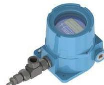
The HY-ALERTA™区域监测仪是工业市场的可靠，一致的氢气检测器。H2scan使用固态非消耗性传感器直接测量空气或惰性气体中的氢气，对其他可燃物没有交叉敏感性。
